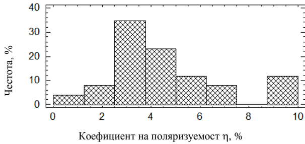
Фиг. 8. Хистограма на разпределението на коефициента на поляризуемост \eta за гранодиорити от сондажи С – 60, С-61 и С-62 в участък Попинци – Попово дере: извадка за \eta < 10\%
